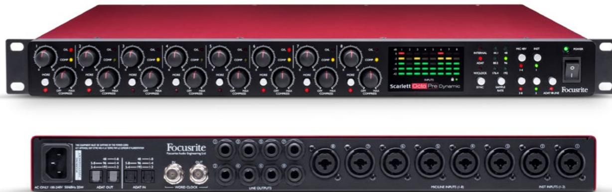
在 Scarlett OctoPre 的基础上, Scarlett OctoPre Dynamic 增加了模拟压缩和 D/A 转换。Scarlett OctoPre Dynamic 型号增加了 8 通道 24/192kHz D-A, 具有 108dB 动态范围, 由一对 ADAT 输入提供。一个按钮可通过 D-A 从 ADAT 输入切换到 8 个线路输出。OctoPre Dynamic 具有经过优化
